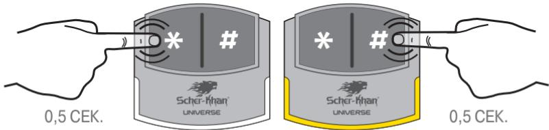
Нажмите клавишу (\*) на модуле КОММАНДЕР количество раз, равное четвертой цифре ПИН-кода. Нажатием клавиши (#) подтвердите ввод четвертого набранного числа. Индикатор при этом светится голубым цветом
