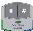
Равномерное мигание (одна вспышка в три секунды) индикатора системы с переходом из зеленого цвета в синий указывает на нахождение системы в режиме охраны и отсутствие тревог.
