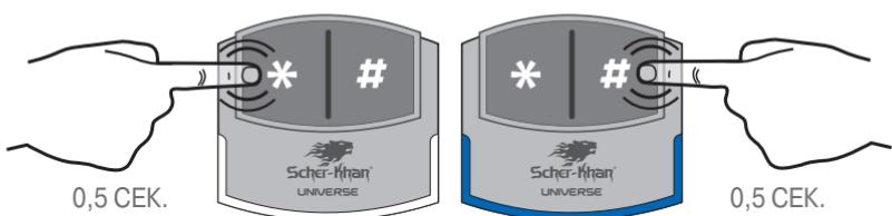
Нажмите клавишу (\*) на модуле КОММАНДЕР количество раз, равное третьей цифре ПИН-кода. Нажатием клавиши (#) подтвердите ввод третьего набранного числа. Индикатор при этом светится желтым цветом
