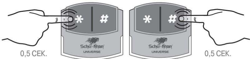
Нажмите клавишу (\*) на модуле КОММАНДЕР количество раз, равное второй цифре ПИН-кода. Нажатием клавиши (#) подтвердите ввод второго набранного числа. Индикатор при этом светится синим цветом
